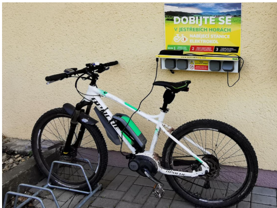
Obrázek 18 Dobíjecí stanice elektrokol
